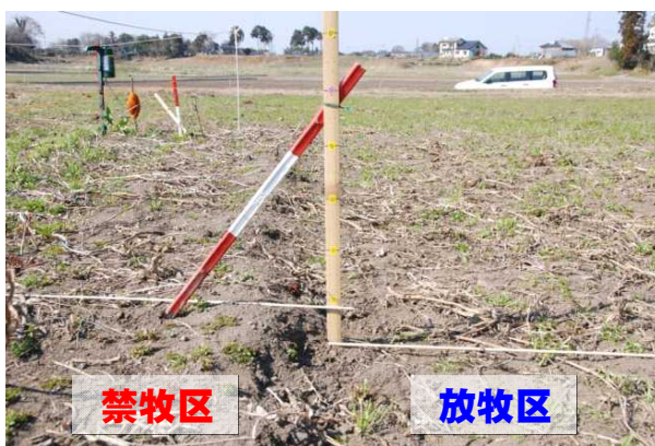
図1 放牧による土壌の圧密化。
