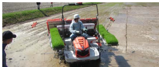
図 1 直進キープ田植機による水稻移植作業
